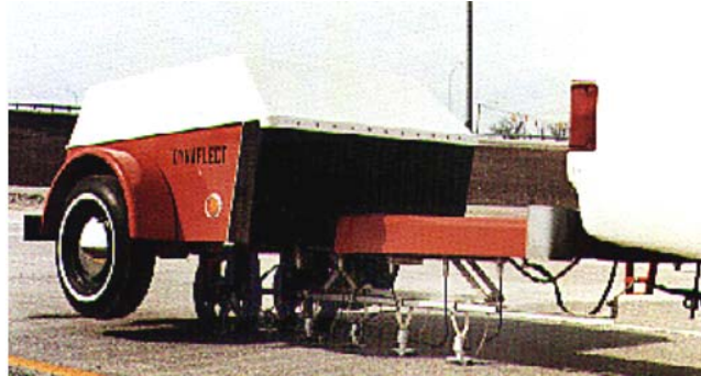
شکل (۳-۲-۱-۱) داینافلکت در موقعیت آزمایش [۲]
