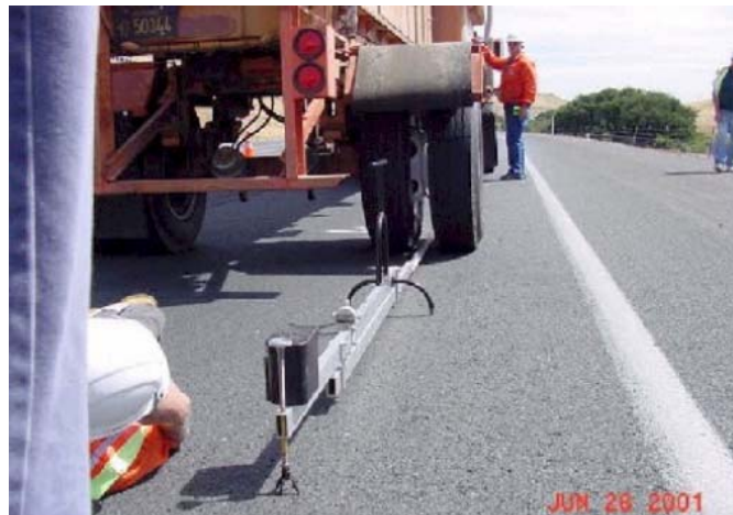
شکل (۳-۱-۱-۱) تیر بنکلمن - دستگاه افت و خیز سنج استاتیکی [۴]
