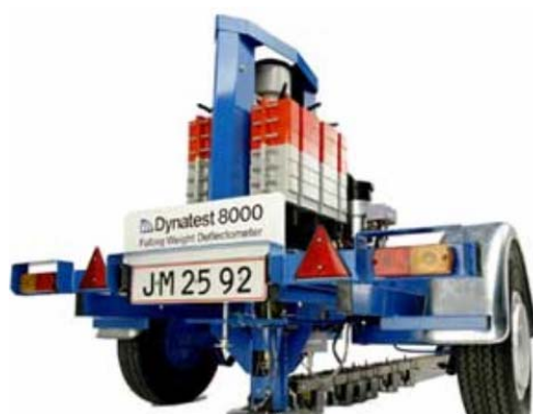
شکل (۳-۳-۱) یک مدل Dynatest FWD دستگاه افت و خیز سنج ضربه ای [۳]
